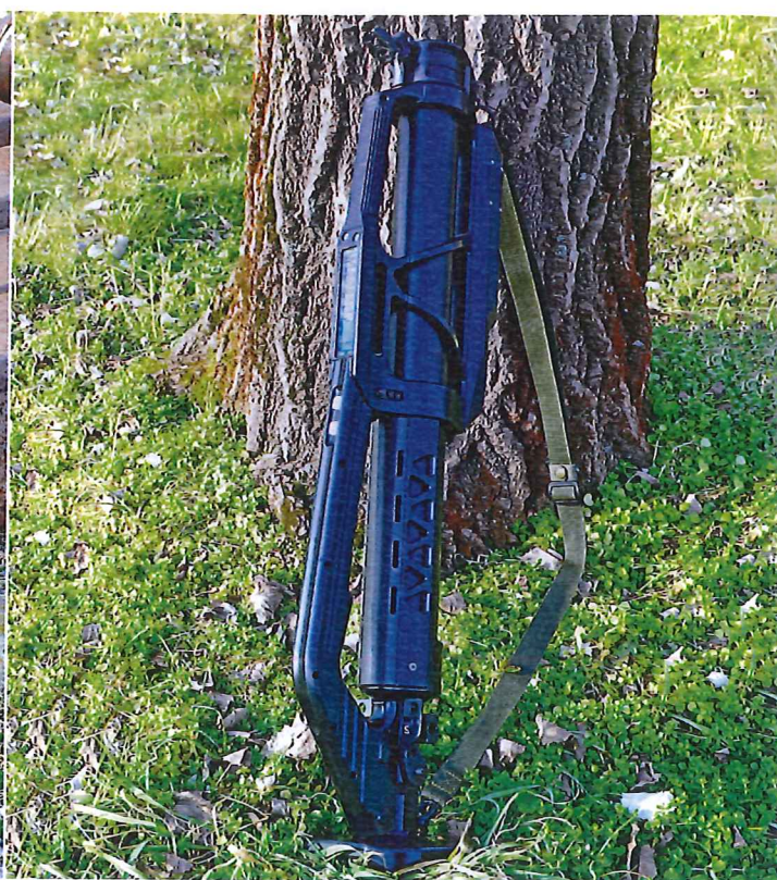
Z tego ujęcia można dostrzec działanie cieczowego celownika grawitacyjnego, który prócz pomiaru odległości służy też do wypoziomowania moździerza. Poniżej okna celownika widać dwa przyciski do podświetlania skali celownika.
