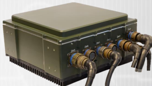
Komputer pokładowy SKO dla zdalnie sterowanych modułów uzbrojenia ZSMU.
