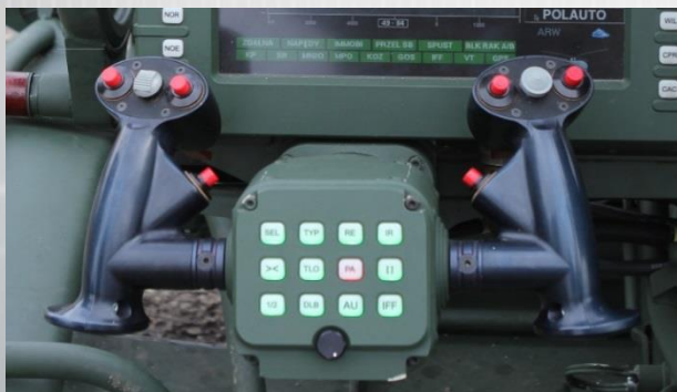
Dwuosiowy manipulator typu Wolant (Zainstalowany na stanowisku operatora JO PSR-A PILICA)
