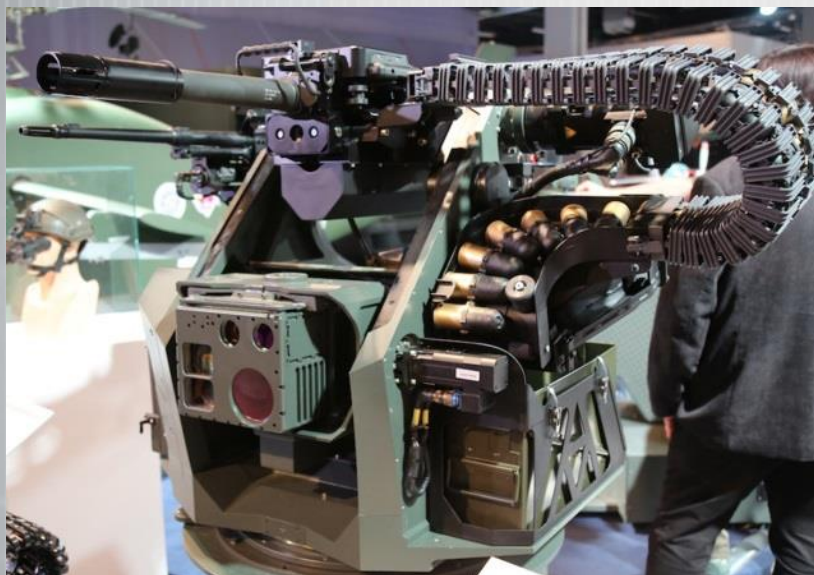
ZSMU A5 w konfiguracji z granatnikiem automatycznym H&K GMG 40 mm
